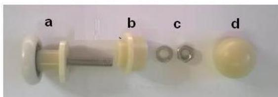
Снимите с роликов колпачки/d/, открутите гайки /с/. Разберите ролики. Вставьте шайбу с эксцентриком /b/ в отверстия на стеклах дверей с внутренней стороны, с внешней стороны стекла вставьте в нее винт /a/ с надетьм на него роликом, и прикрутите его с помощью гайки /с/, не затягивая ее.
