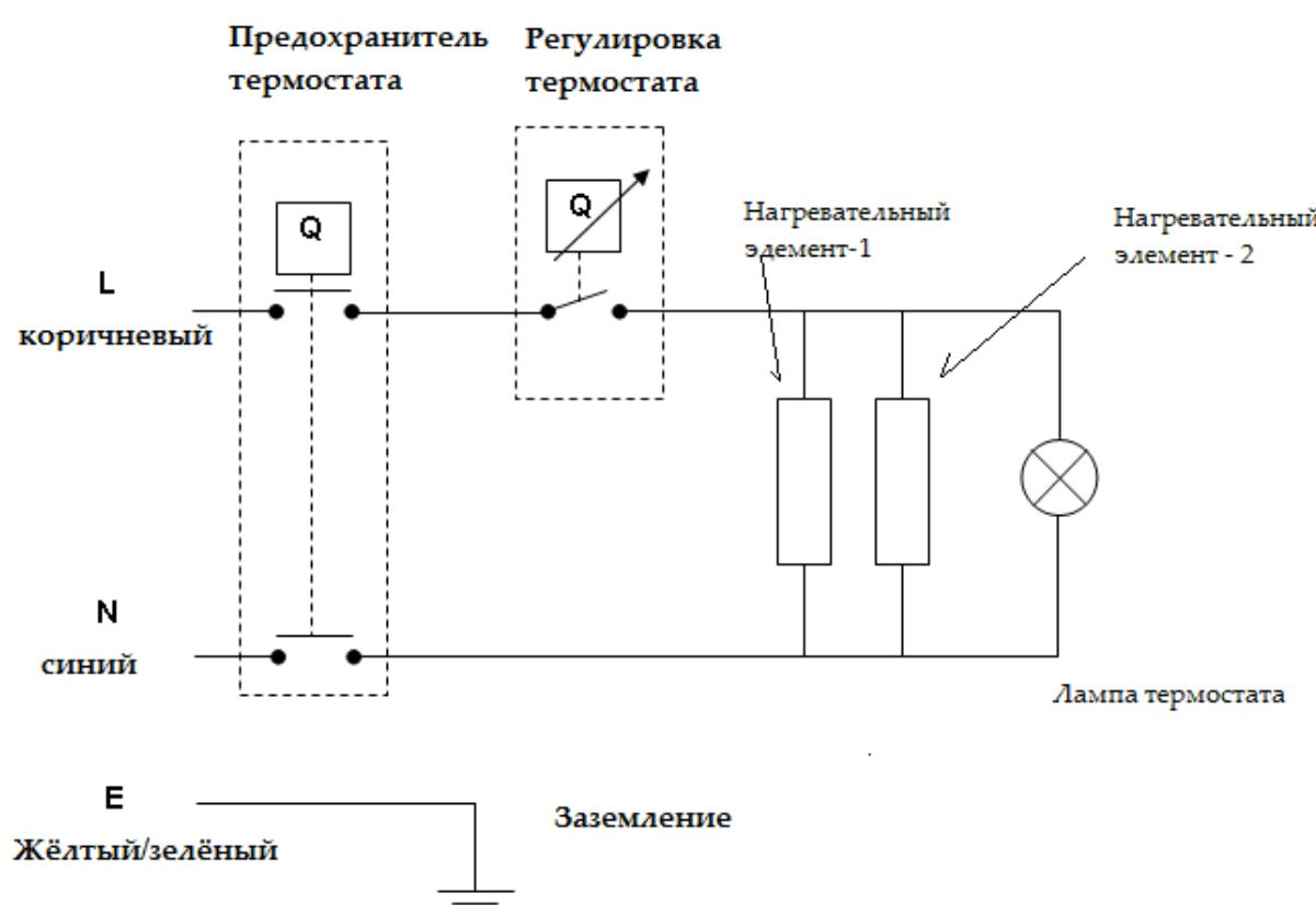
Рис. – 4 APARICI – ТОР электрическая схема.
