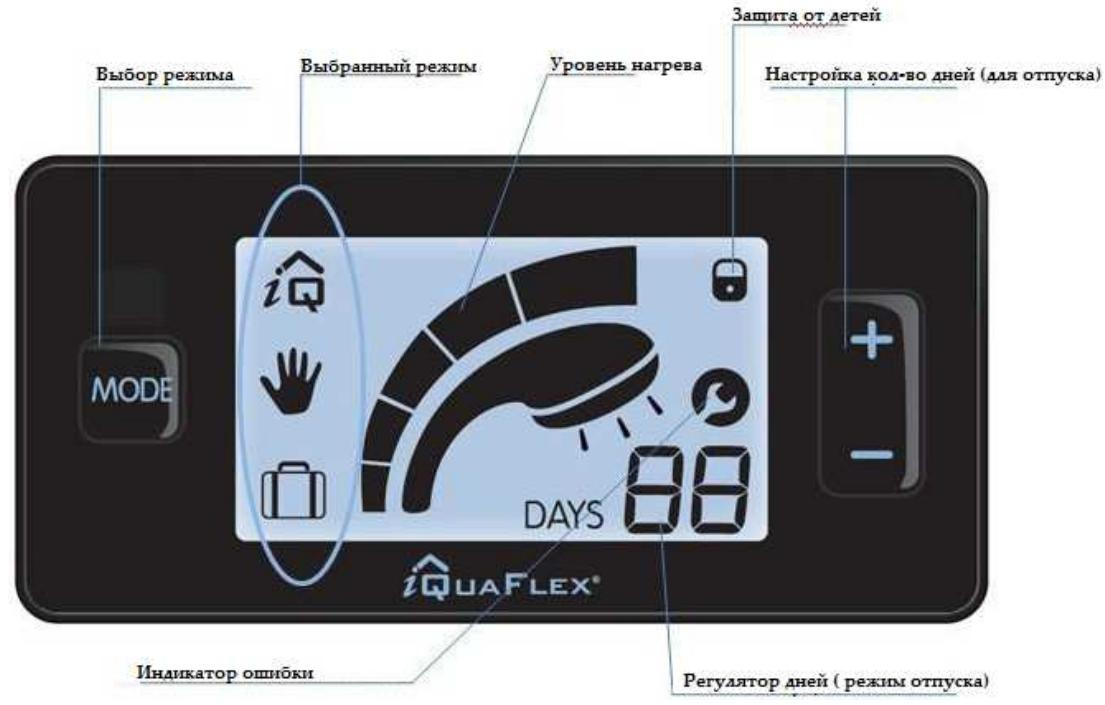
Интерактивный LCD экран имеет 3 кнопки для регулировки: **MODE**, **+** и **-**, которые позволяют установить конфигурацию, которая будет удобна для каждого. Кнопка MODE позволяет выбрать подходящий режим, среди которых есть :
